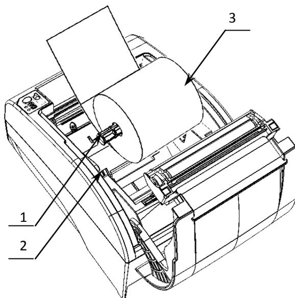
Рисунок 10. Заправка бумаги при вертикальной установке ККТ
