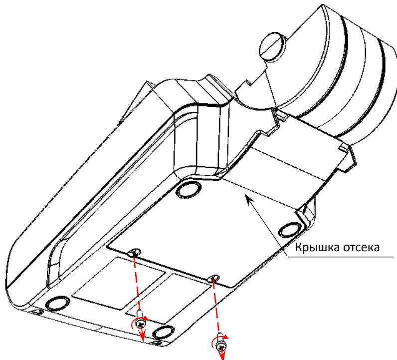
Рисунок 10. Снятие крышки отсека (открутить винты крепления)
