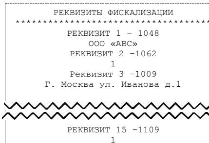
Можно распечатать реквизиты в более удобном (читабельном) формате без номера и тега. Для этого нужно выйти из подрежима ввода реквизитов – нажать клавишу [РЕ] (на дисплее отобразиться **r1-2**), затем войти в подрежим печати реквизитов – нажать клавишу [2]. При этом будет распечатан документ, содержащий все запрограммированные реквизиты в виде, в котором они будут печататься в фискальных документах.
