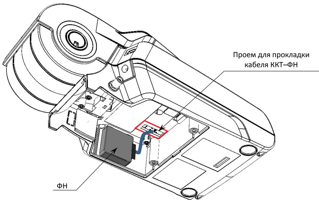
Рисунок 13. Расположение ФН в нижней части корпуса изделия
