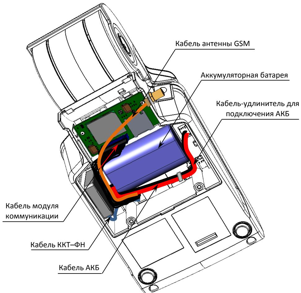
Рисунок 12. Расположение основных составляющих и кабелей в отсеке корпуса ККТ
