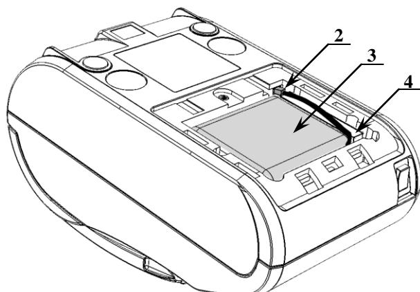
Рисунок 6. Подключение АКБ
