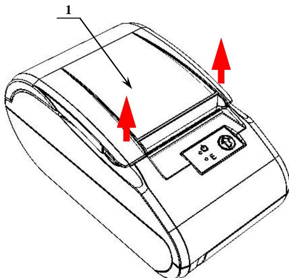
Рисунок 7. Места приложения усилий при открытии крышки
