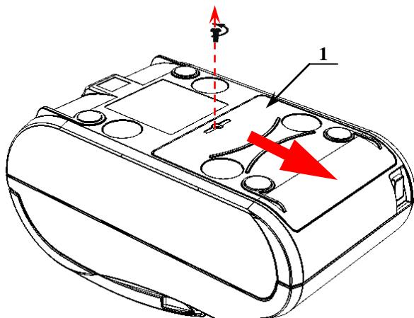
Рисунок 5. Снятие крышки
