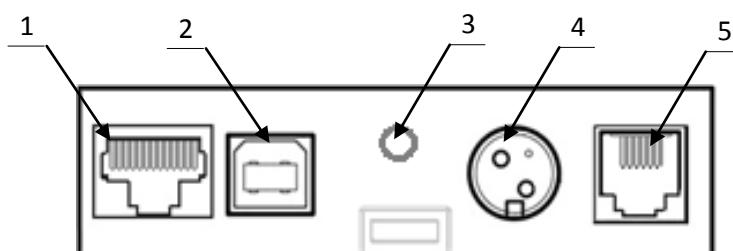
Рисунок 4. Разъемы для подключения внешних устройств к ККТ
