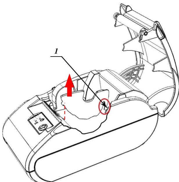
Рисунок 13. Извлечение фиксатора-защелки из паза в лотке ЧЛ
